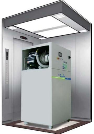
必信智磁™ ( I-CHILLER™ ) 系列磁悬浮无油变频离心式冷水/热泵模块机组是一款专门为既有建筑改造设计的机组，智磁™系列机组外形尺寸仅1.2mX0.89mX1.8m，重量在1吨至1.3吨之间，无需借助大型器械进行运输，对运输通道和放置空间要求低。同冷量下，仅需传统机组放置面积的60%，完美匹配改造项目的运输通道狭窄、机房空间紧张等特点。
